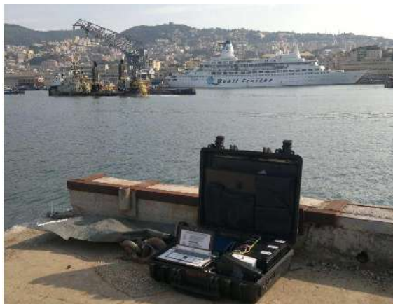
monitoraggio delle vibrazioni indotte dall'esplosione sulle banchine dal brillamento del bacino circostante
