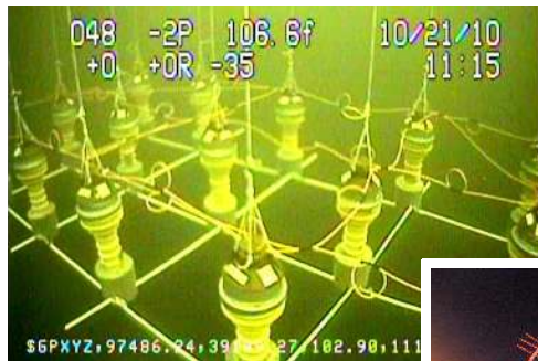
... e monitoraggio video della distribuzione di cariche cave in acque profonde
