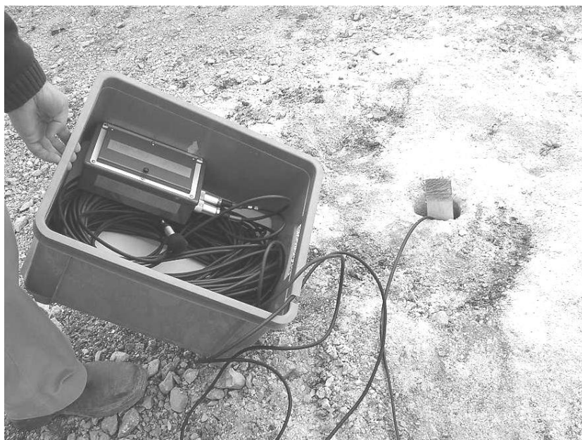
Piazzamento di un geofono fondo foro presso la volata d'abbattimento ed allestimento della stazione di misura per il riscontro della sismicità indotta necessario all'ottimizzazione della volata.
