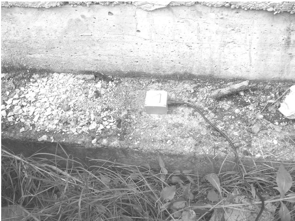
Semplice accoppiamento del trasduttore all'elemento strutturale (trave di fondazione, per valori di accelerazione previsti inferiori a 0,1 g.
