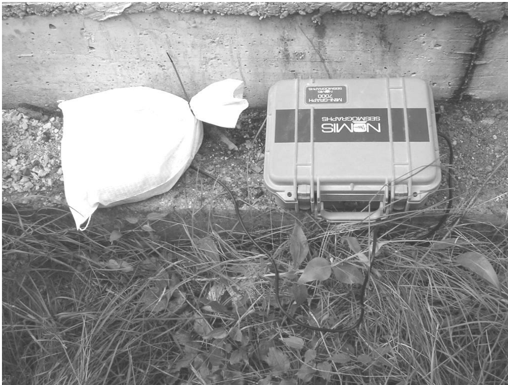
Copertura del trasduttore con sacco di sabbia e semplice accoppiamento del trasduttore all'elemento strutturale (trave di fondazione, per valori di accelerazione previsti inferiori a 0,1 g). Stazione di monitoraggio dentro il suo contenitore, alimentato a batteria (tempi di monitoraggio limitati ad una settimana, 10 giorni).
