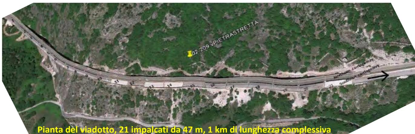
Pianta del viadotto, 21 impalcati da 47 m, 1 km di lunghezza complessiva
